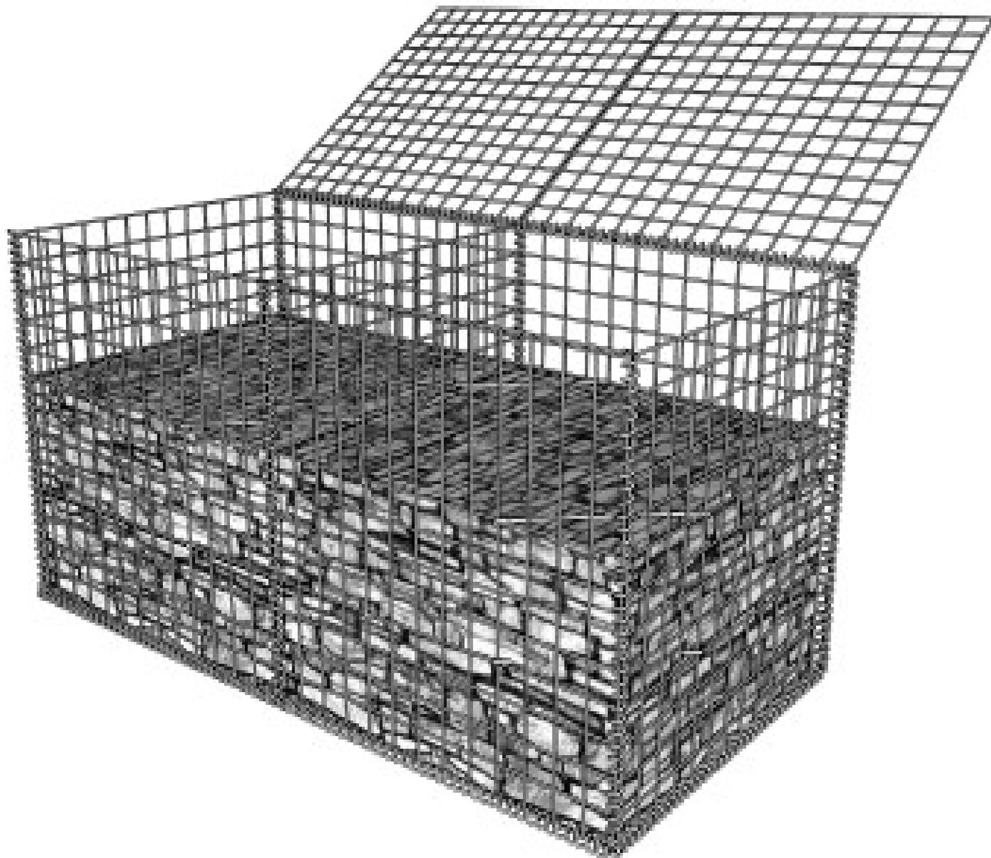
Remplissez le gabion jusqu'à 2/3 de la hauteur et installez à nouveau les tirants.
