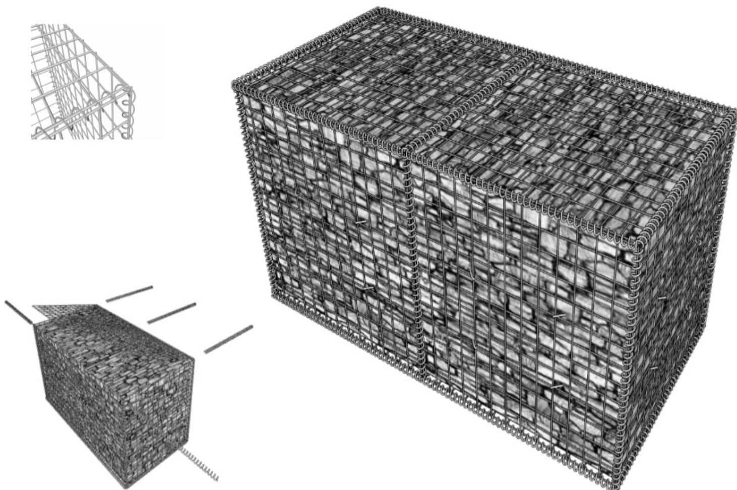
**CONSEIL** Toujours terminer en tournant les bouts des spirales vers l'intérieur afin d'éviter tout risque de blessure ou le dévissage des spirales.
